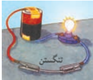
ب - سیم تنگستن در بین دو گیره سوسماری.
